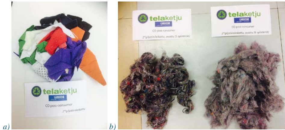
Kuva 7 a) Giljotiinileikattu kangassilppu, b) Mekaanisesti avattuja kuituja. Kuvat ovat Telaketju-projektin demoajosta Larochen tehtaalta
