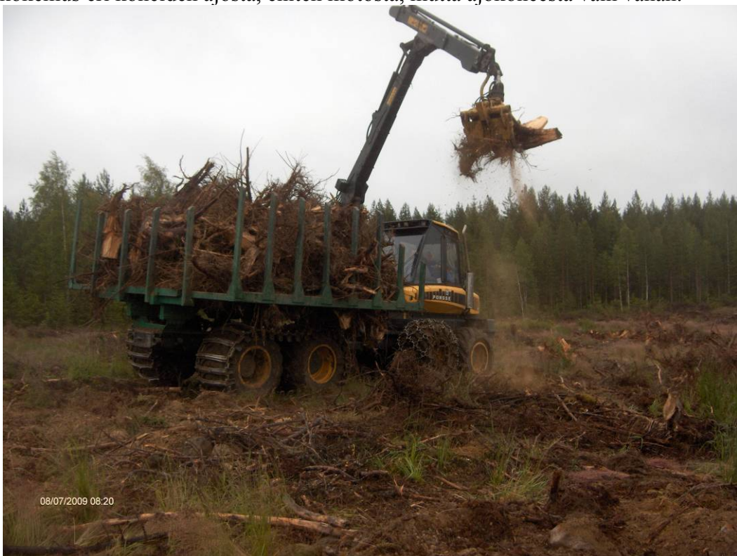
Kuva 17. Joensuussa kannot kuormattiin ravistelevalla kouralla metsäperävaunuun, jonka kuormatila laajenee. Kuva: Ari Erkkilä
