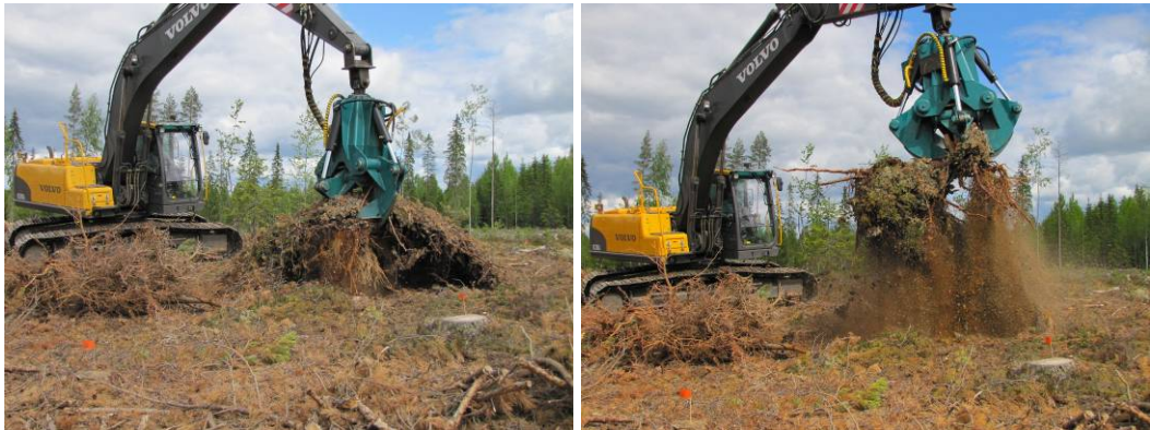
Kuva 11. Xteho-yksiotekantoharvesterin ominaisuuksia kantojen nostossa tutkittiin Joensuussa ja Toivakassa. Kuvat Toivakasta. Kuvat: Ari Erkkilä
