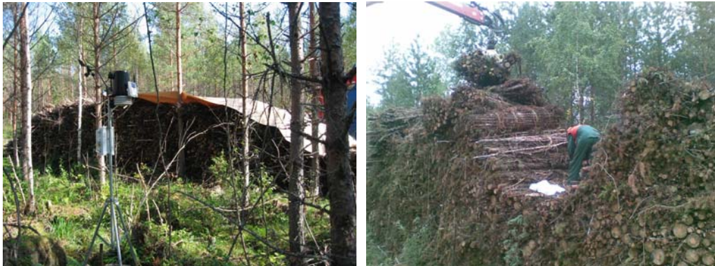
Kuva 24. Sään mittaamiseen käytetty sääasema, taustalla puoliksi peitetty varastokasa. Kosteusnäytteiden ottoa kasasta (oikealla). Kuvat: Kari Hillebrand
