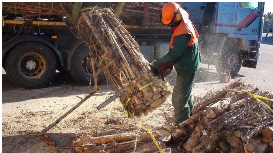
Kuva 3. Kosteusnäytteiden sahaaminen seurannan lopussa. Kuva: Ari Erkkilä
