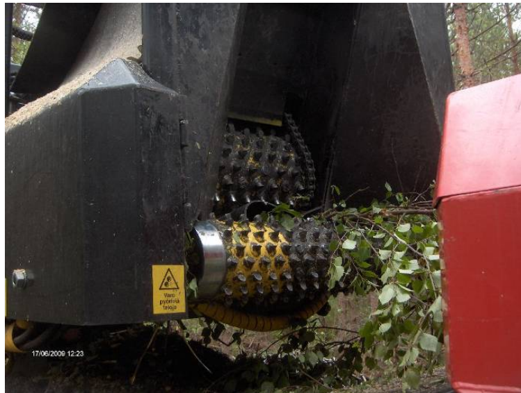
Kuva 2. Fixterin syöttörullat kokeiden aikana. Kuva: Ari Erkkilä
