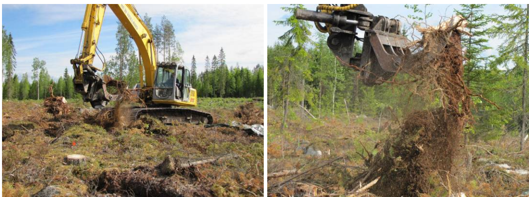
Kuva 12. Kantohara oli vertailukoneena mäntykantojen nostossa Toivakassa. Kuvat: Ari Erkkilä
